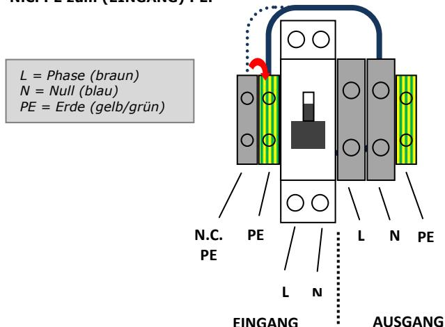
Ziehen Sie nach dem Anschließen die Schraubverbindungen gut an.
