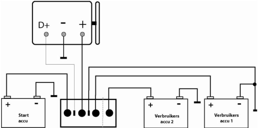
Indien u op de dynamo niet de beschikking heeft over de D+ aansluiting, kunt u de D+ van de diodeverdeler verbinden met het contactslot.
